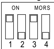
Bild 5: DIP-Schalterreihe mit der Basisadresse 150H
