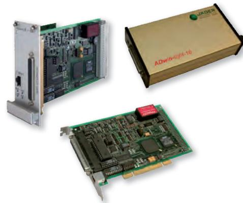
ADwin-light-16 propose des fonctionnalités similaires à ADwin-Gold II, avec un nombre réduit de canaux. Basé sur un design commun, il existe 3 différentes versions : Une carte format PCI, une carte au format Europe, un système en boîtier métallique robuste.
