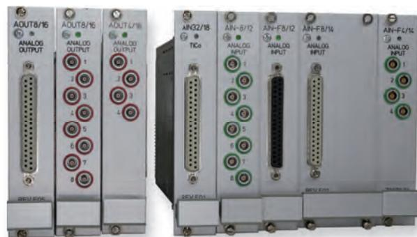
Divers modules d'entrée analogique et de sortie analogique
