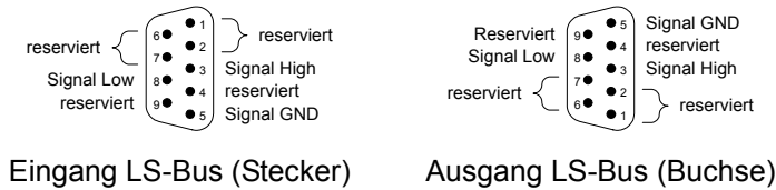
Abb. 3 – Pinbelegung LS-Bus HSM-24V
