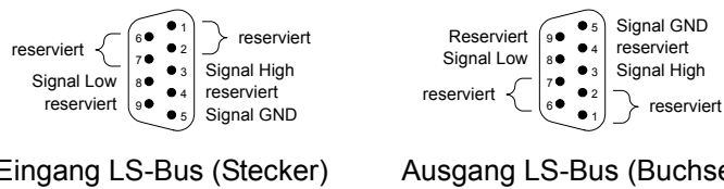
Abb. 3 – Pinbelegung LS-Bus HSM-24V
