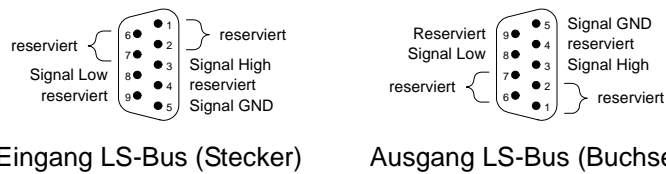
Abb. 4 – Pinbelegung LS-Bus HSM-24V
