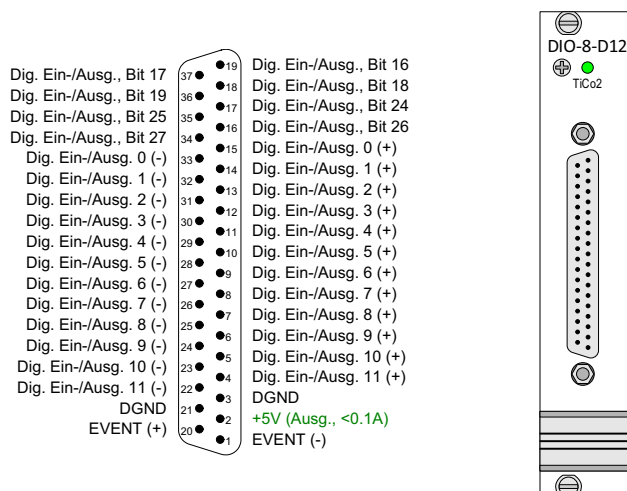
Abb. 101 – Pro II-DIO-8-D12 Rev. E: Pinbelegung
